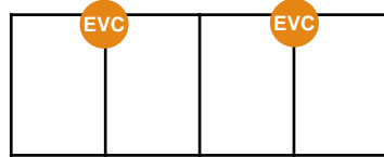
EV 4 台分を充電器2基設置でシェア
